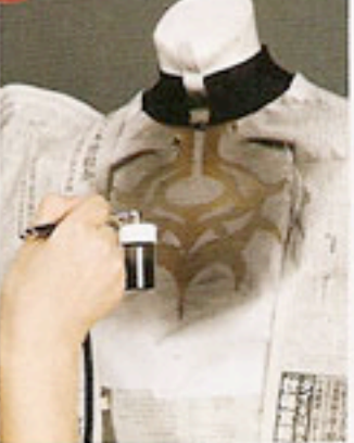
塗りムラにならないよう10cmほどの近い距離で一気に吹き付ける。
